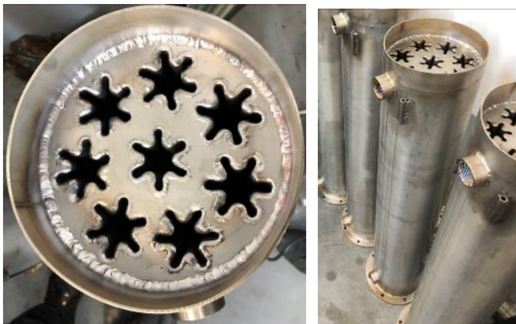
Rys. 2. Widok wymiennika kotła sonicznego typu „KS” w postaci profili walcowanych w kształcie gwiazdy sześcioramiennej
