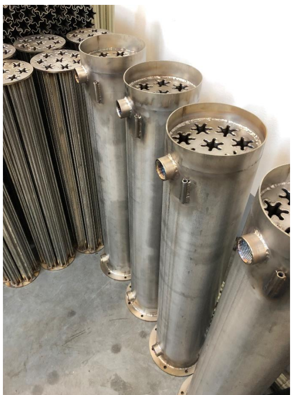
Fot. 4. Ogólny widok wymiennika kotła sonicznego centralnego ogrzewania typu KS
